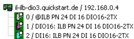
Bild 3-8 Gerätestellvertreter und Module eines PROFINET IO-Devices
