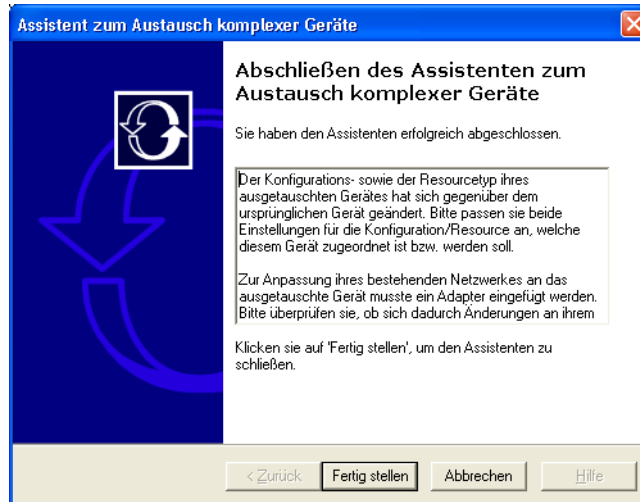
Bild A-6 Fertigstellen des Austauschs
